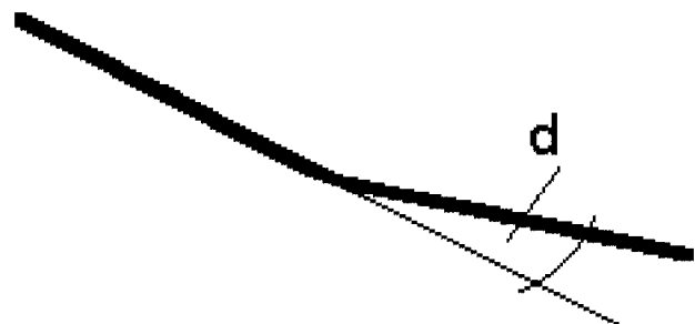
Rys. 4 Warunki dotyczące pochyłeń podłużnych drogi startowej
