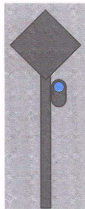
Rys. 48. Sygnał M 1 (nocny)
