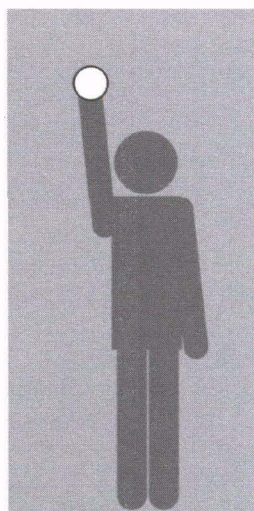
Rys. 123. Sygnał Rh 3 (nocny)
