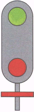
Rys. 17. Sygnał S 10a
