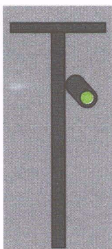
Rys. 32. Sygnał Od 2 (nocny)
