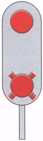
Rys. 205. Sygnał S 1a
