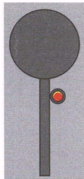
Rys. 73. Sygnał DO (nocny)
