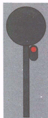
Rys. 30. Sygnał Od 1 (nocny)
