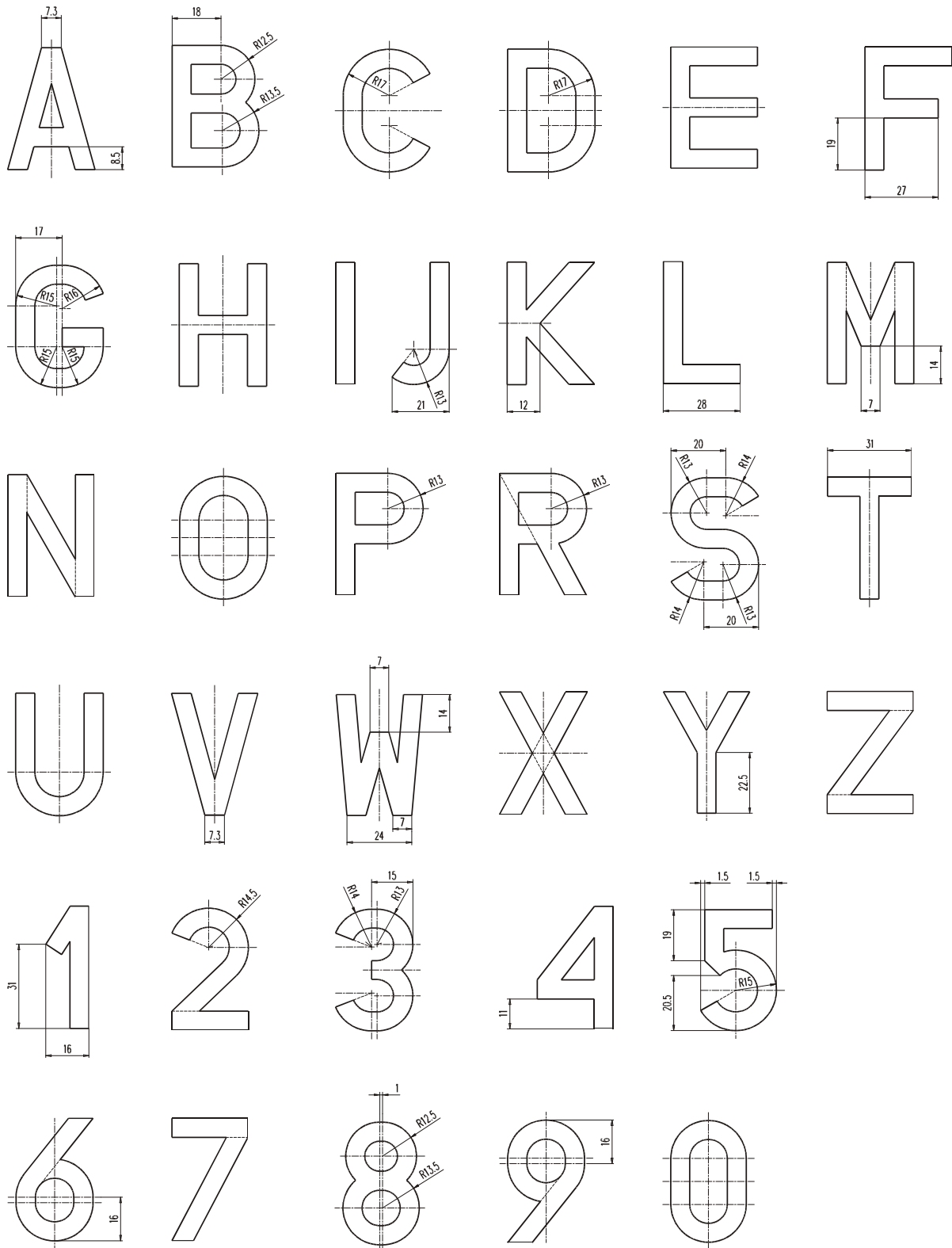
Rysunek 8. Wzory liter i cyfr do tablic motocyklowych
