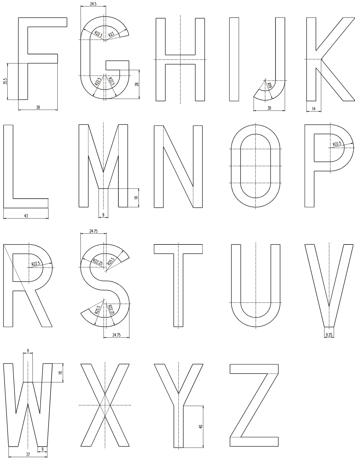
Rysunek 7. Wzory zwężonych liter do tablic samochodowych.
