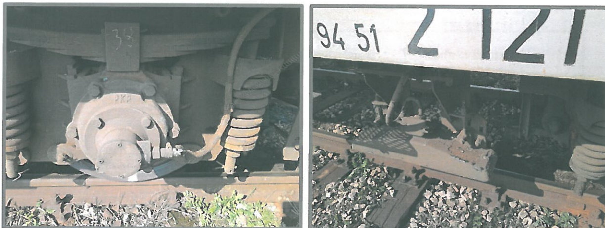
Uszkodzenia w elektrycznym zespole trakcyjnym seri EN57-1292 po wypadku
