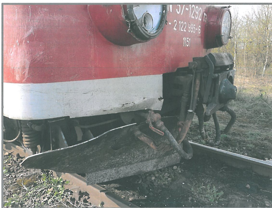
Widok elektrycznego zespołu trakcyjnego serii EN57-1292 po wypadku
