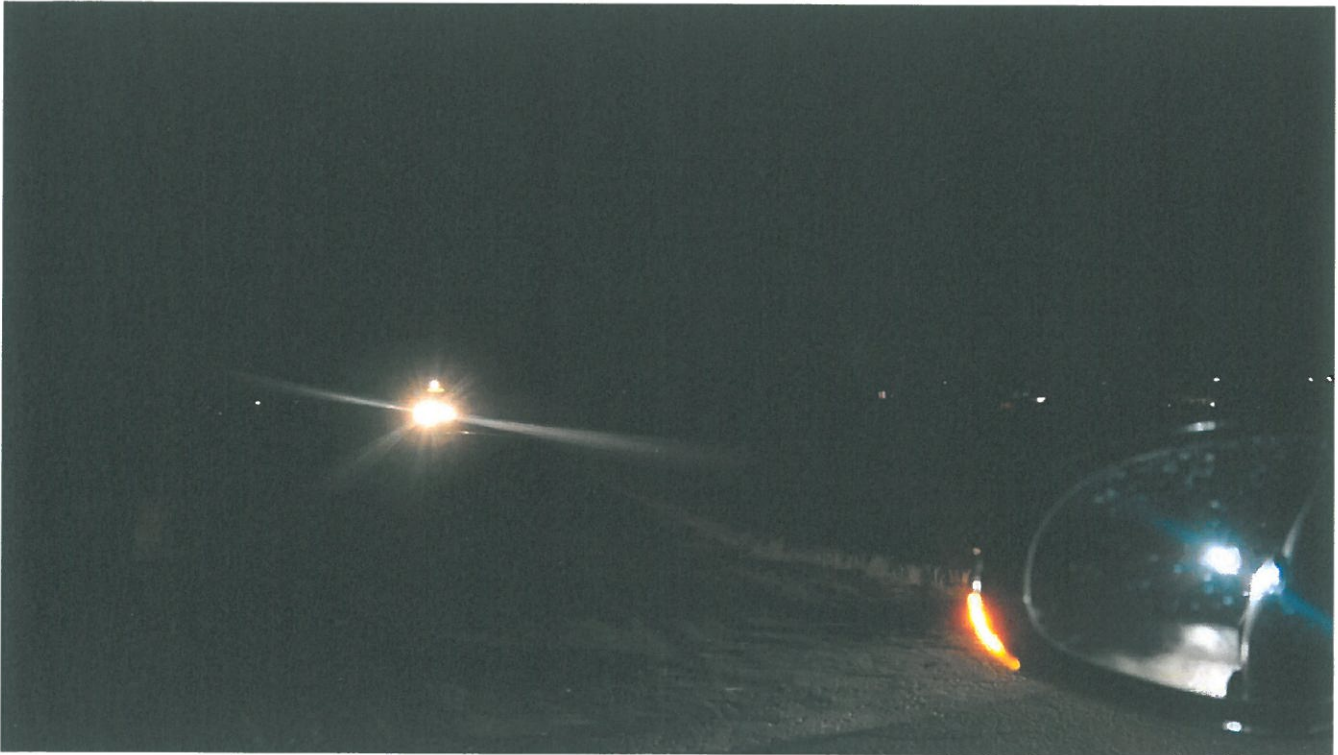
Fot. 9. Widok czoła pociągu z pozycji kierowcy na 4 sekundy przed wjechaniem pociągu na przejazd (zdjęcie wykonane przez Zespół badawczy w podobnych warunkach jak w dniu wypadku).
