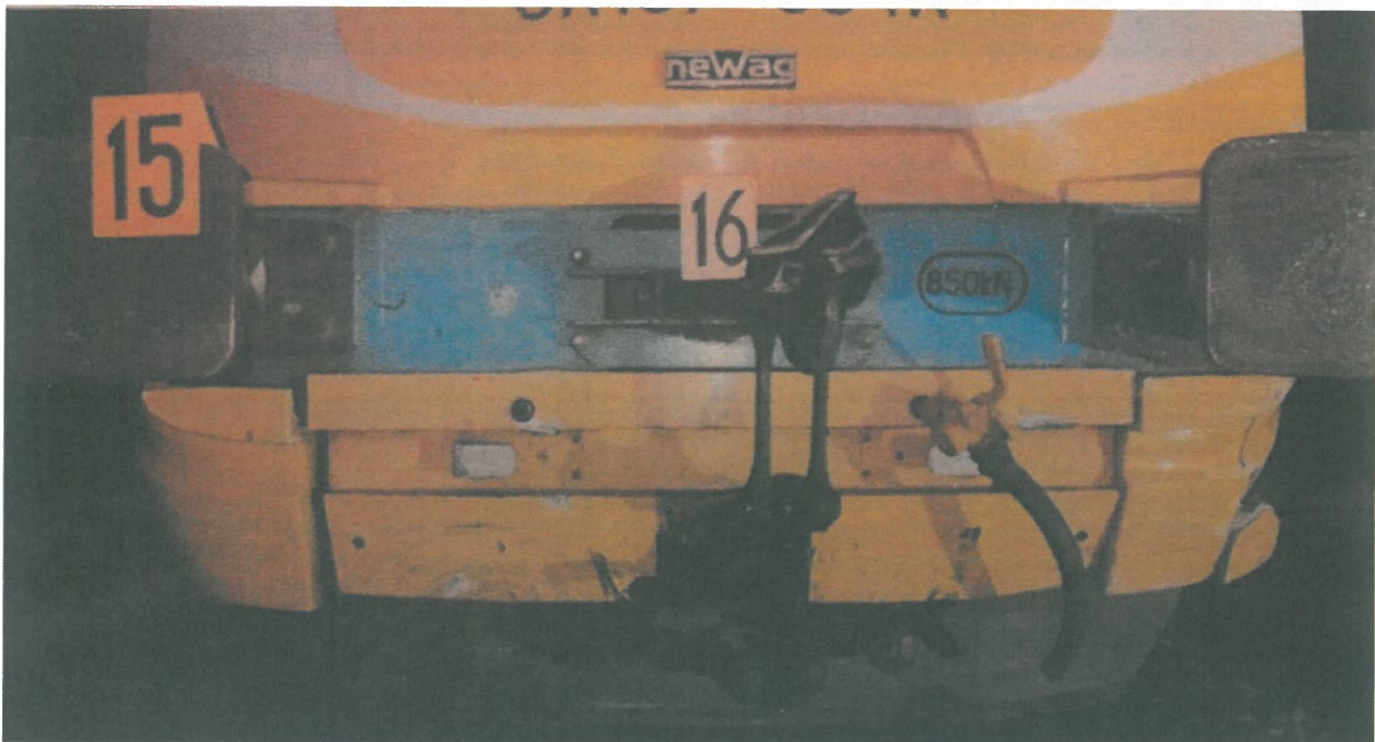
Fot. 12 i 13. Uszkodzenia szynobusu
