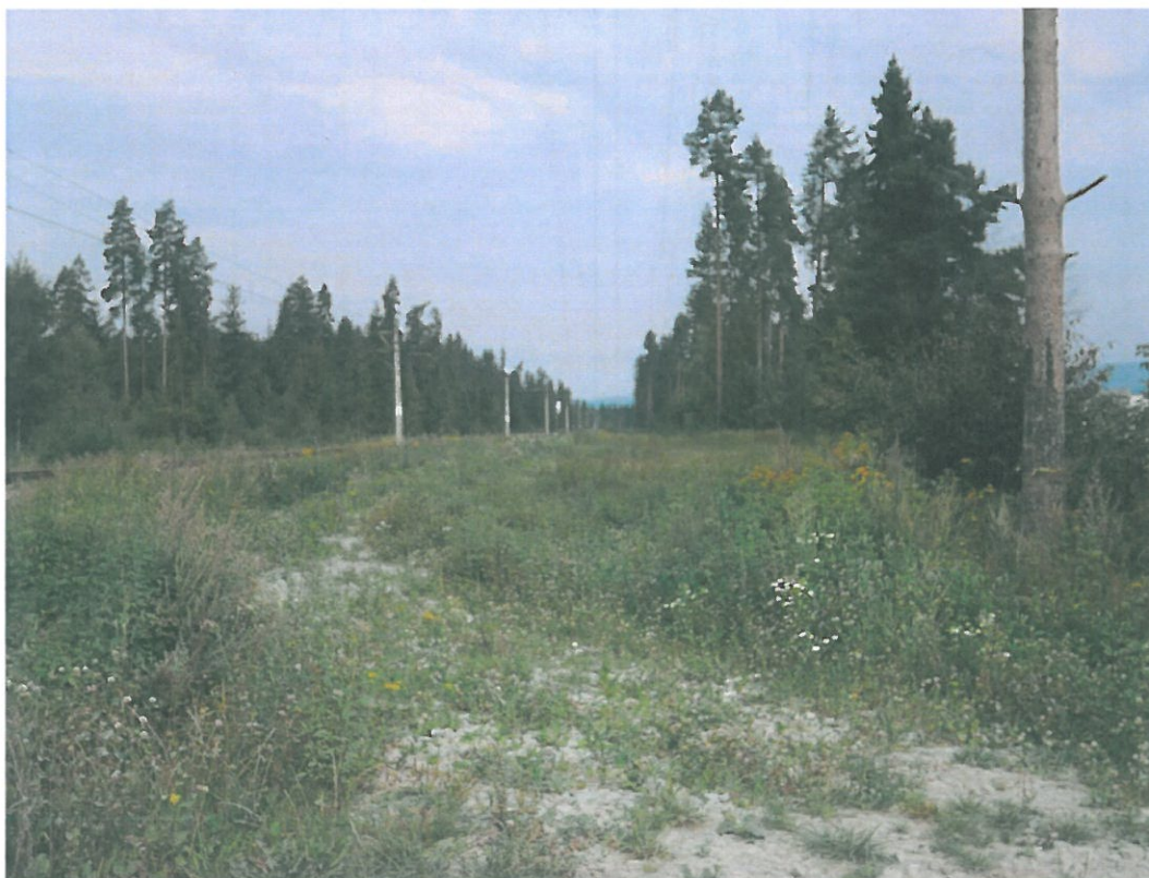
Fot. 3. Widoczność w porze dziennej z 10 m w kierunku zbliżającego się pociągu (z pozycji kierowcy samochodu osobowego)
