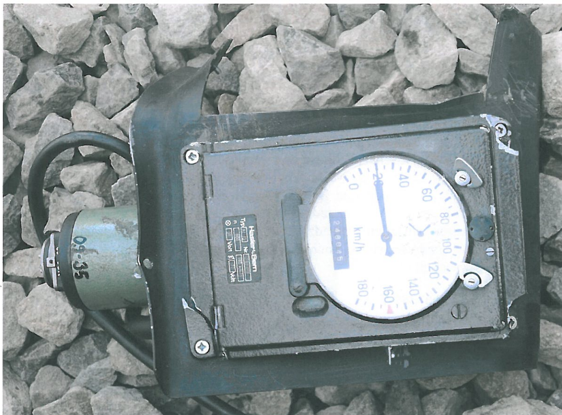
Fot. II.2c.2 Rejestrator Hasler z kabiny A lok. EP09-035 (mat. Prok. Okr. Częstochowa)
