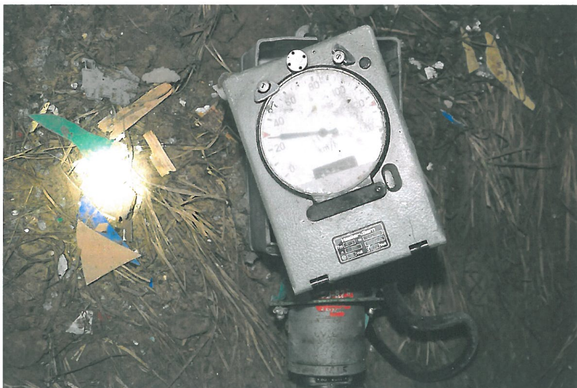
Fot. II.2c.1 Rejestrator Hasler z kabiny A lok. ET22-1105 (mat. Prok. Okr. Częstochowa)
