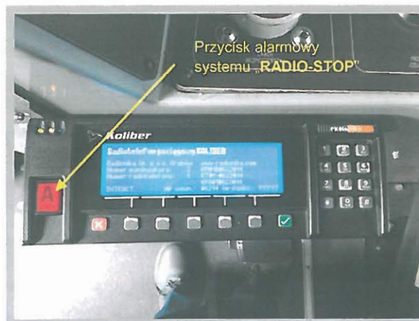
Manipulator typu KM-01 radiotelefonu pociągowego typu „ KOLIBER ”
