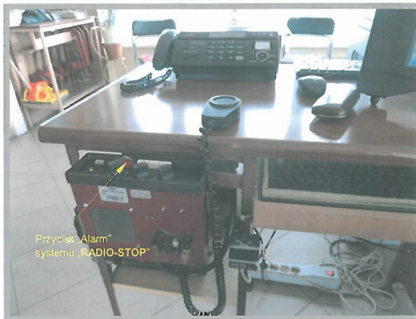
Manipulator radiotelefonu pociągowego typu FM3206 „RADMOR” .
