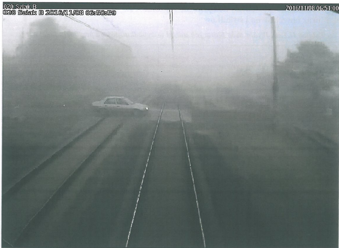
Fot. 2. Obraz z kamery video na pokładzie lokomotywy na ok. 1 s przed zderzeniem
