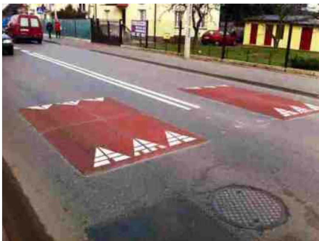
Rysunek 6-6 Przeszkody poprzeczne - nieszkodliwe dla autobusów, zmuszające do zwolnienia samochodów osobowych
