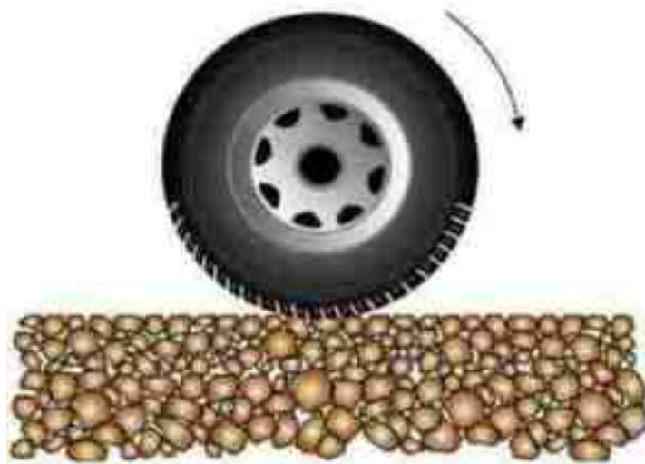
Rysunek 6-3 Asfalt porowaty o dużej zawartości próżni
