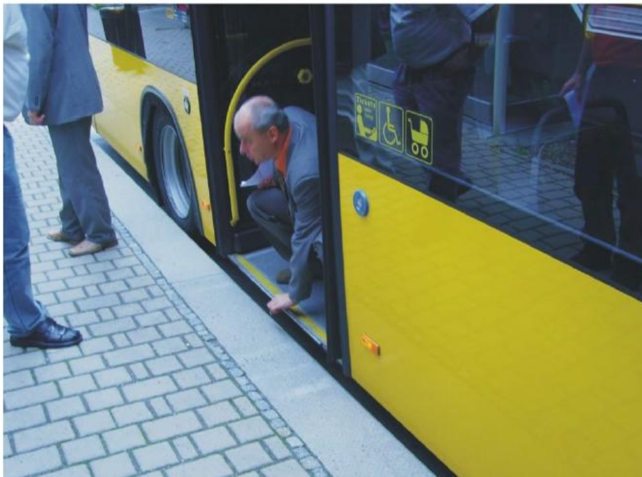
Rys. 3.4.2. Wymagany efekt wprowadzenia peronów podwyższonych do poziomu podłogi w pojazdach
