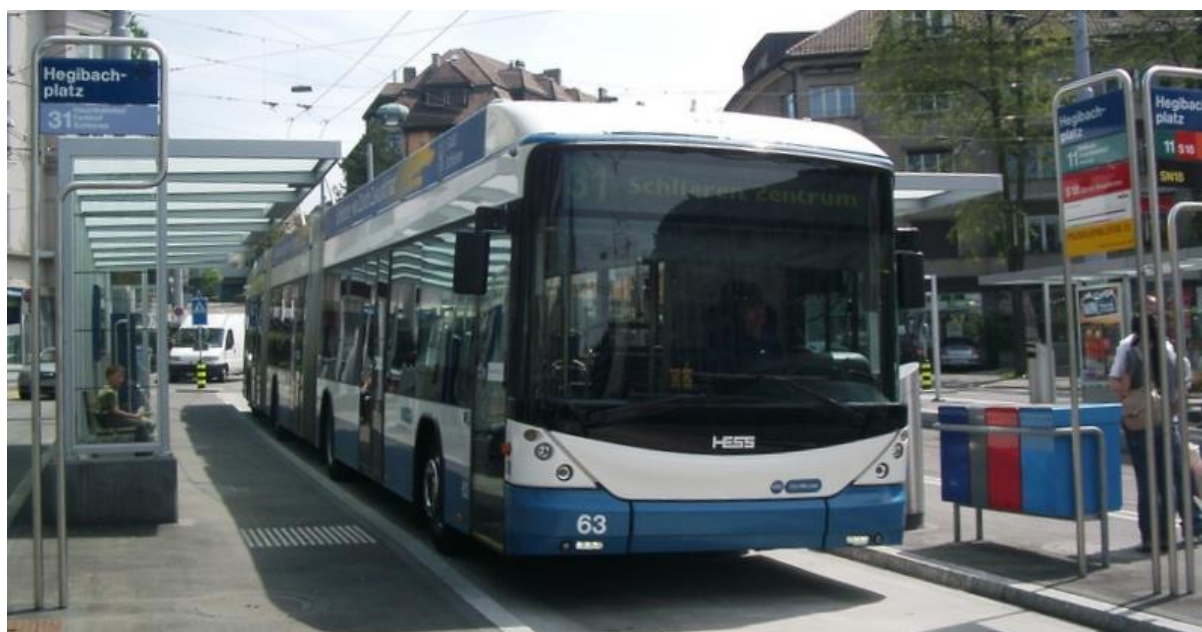
Rys. 11.1.2. Przykład węzłowego przystanku autobusowego ze słupkami zawierającymi numery linii utrzymane w zgodzie z przyjętą kolorystyką na schematach tras (Zürich, Szwajcaria)
