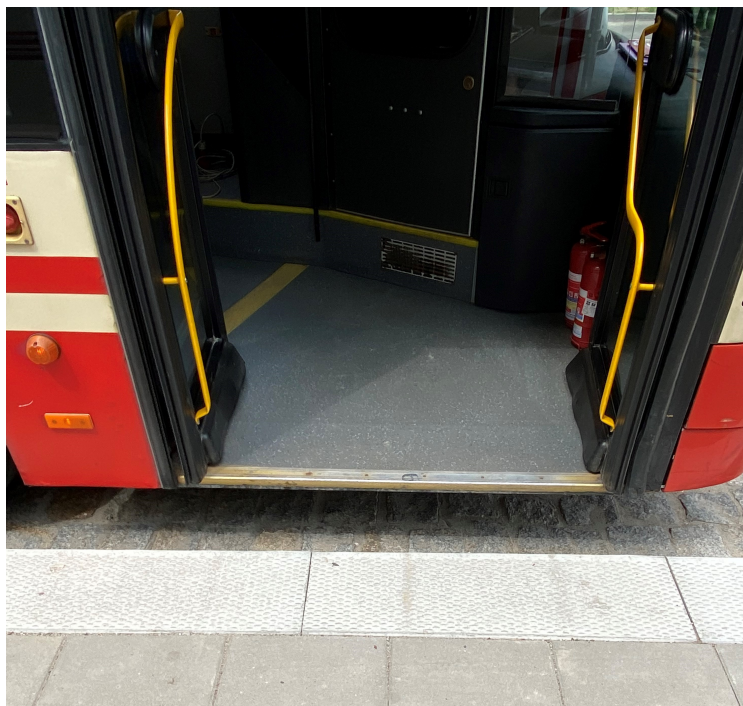
Rys. 9.4 Zminimalizowana przerwa między peronem przystankowym a podłogą w autobusie
