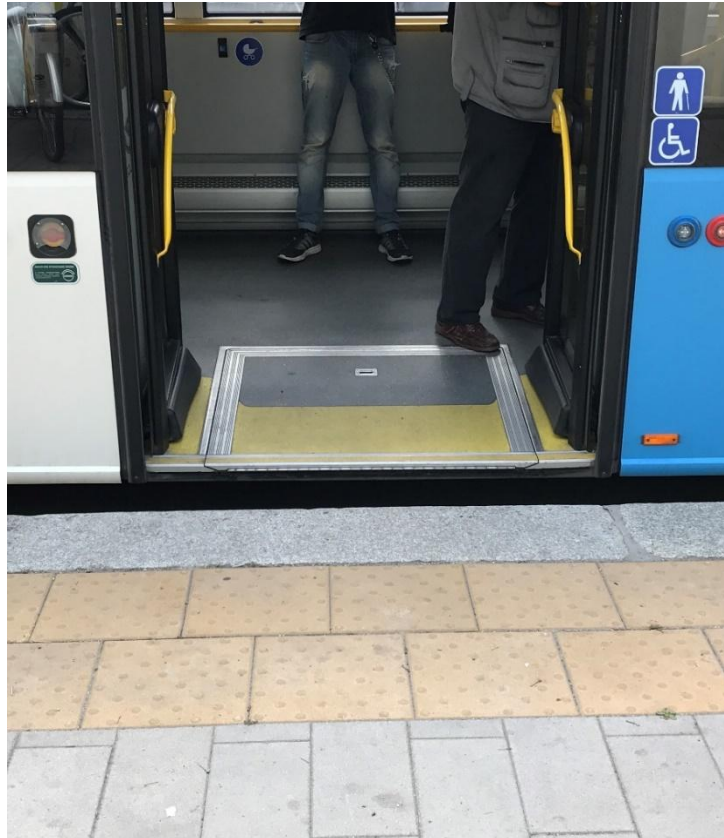
Rys. 8.3 Zminimalizowana przerwa między peronem przystankowym a autobusem.
