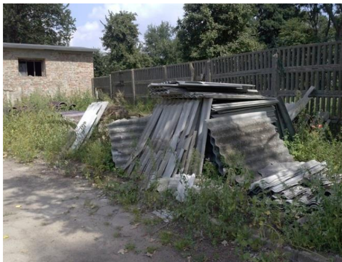
Rysunek 2. Odpady zawierające azbest – zmagazynowane płyty faliste [źródło: materiały własne ]
