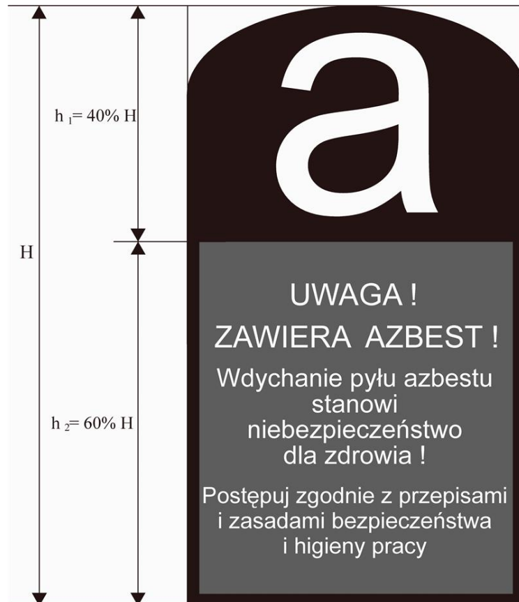
Rys. 3 Wzór prawidłowego oznakowania wyrobów, odpadów i opakowań zawierających azbest oraz miejsc ich występowania.
