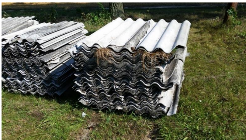
Rys 2. Odpady zawierające azbest – zmagazynowane płyty faliste (źródło: materiały własne)
