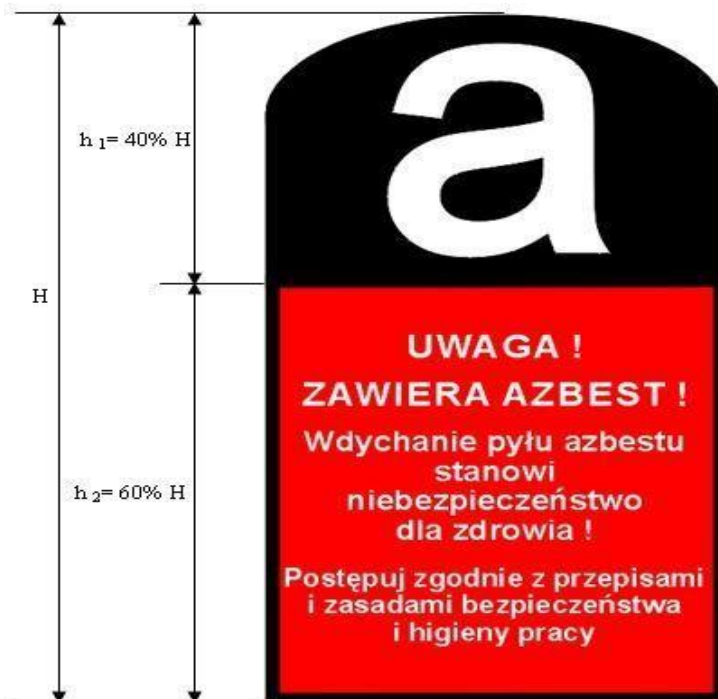
Rysunek 4. Wzór oznakowania instalacji lub urządzeń zawierających azbest oraz rur azbestowo-cementowych
