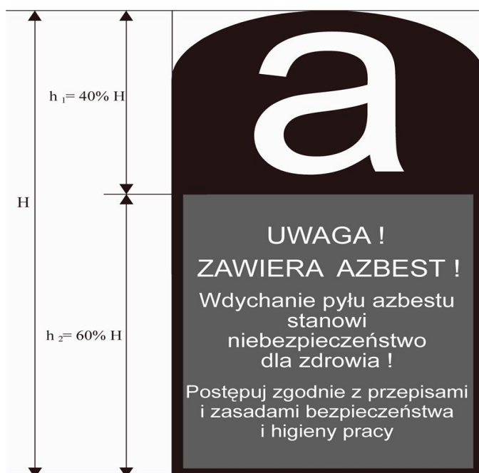
Rysunek 3. Wzór prawidłowego oznakowania wyrobów, odpadów i opakowań zawierających azbest oraz miejsc ich występowania
