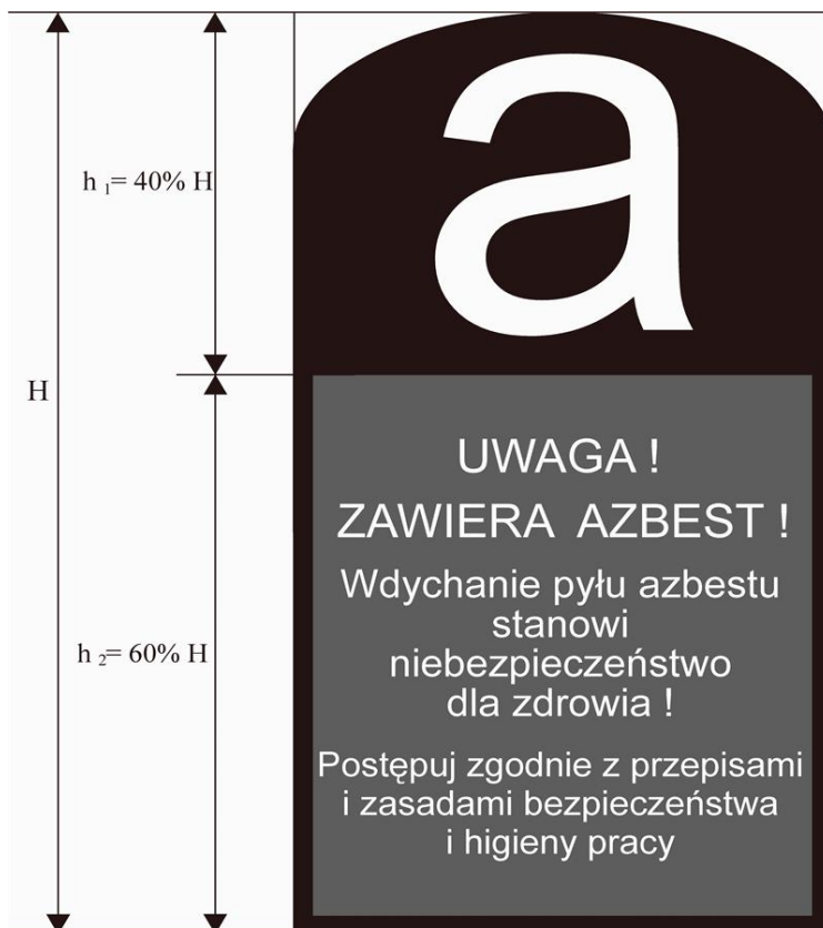
Rys. 3. Wzór prawidłowego oznakowania wyrobów, odpadów i opakowań zawierających azbest, a także miejsc ich występowania
