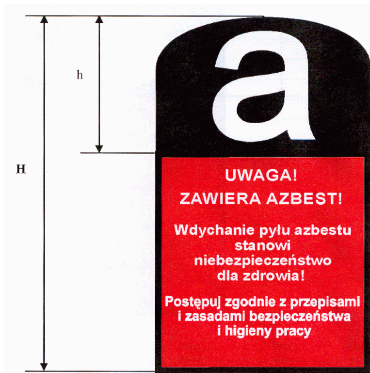
Rys. 5. Wzór oznakowania dróg utwardzonych odpadami zawierającymi azbest (H = min. 30 cm)
