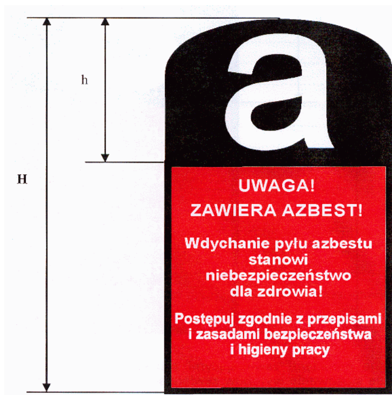
Rys. 6. Wzór oznakowania dróg utwardzonych odpadami zawierającymi azbest ( H = \text{min. } 30 \text{ cm} )
