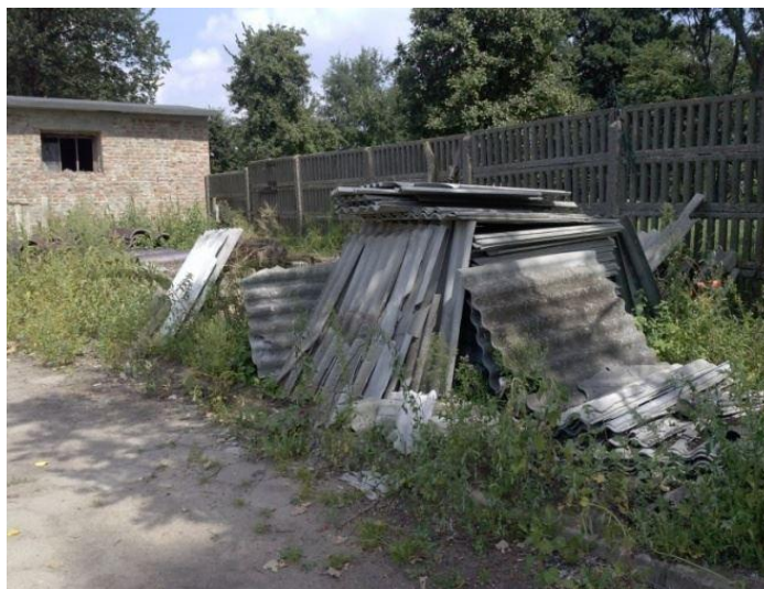
Rys. 2. Złożone płyty azbestowe - faliste (źródło: materiały własne).
