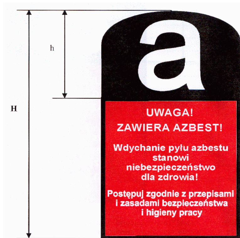
Rysunek 5. Wzór oznakowania dróg utwardzonych odpadami zawierającymi azbest ( H = \text{min. } 30 \text{ cm} )
