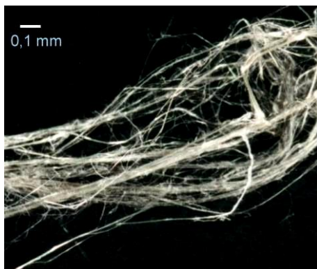
Rys. 1. Długo włóknisty azbest chryzotylowy praktycznie niezawierający zanieczyszczeń (Chiny)
