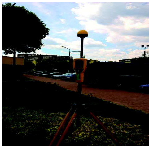
Pomiary monitoringowe PEM (pola elektromagnetycznego) prowadzone przez WIOŚ w Warszawie
