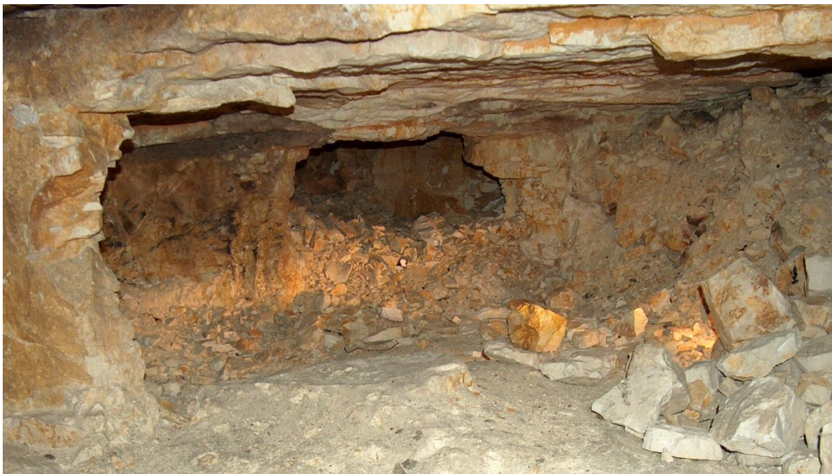
Wnętrze wyrobiska górniczego typu filarowo-komorowego w Krzemionkach
