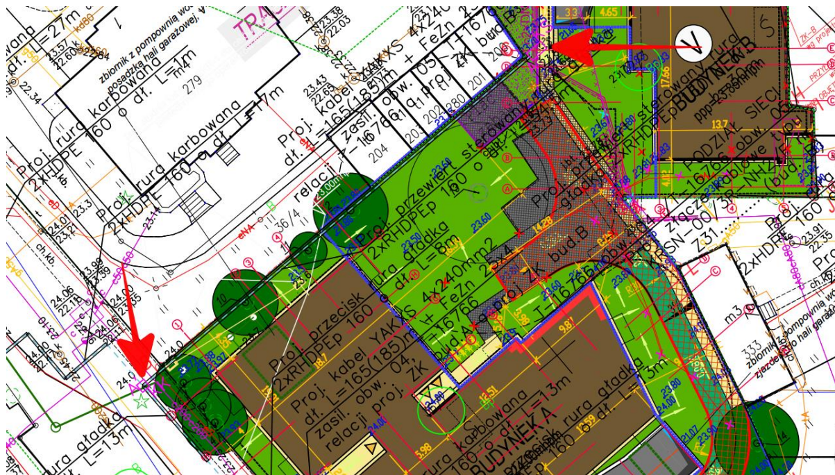
Ryc. 3. Lokalizacja komór startowej oraz końcowej przewiertu sterowanego
