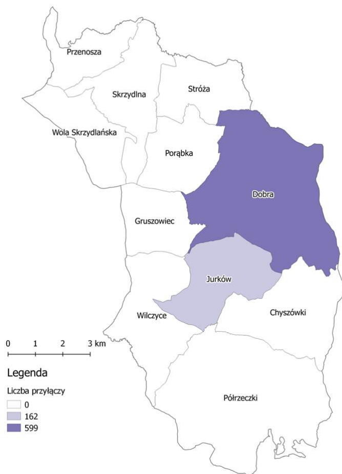
Rys. 1. Gmina Dobra – przyłącza kanalizacyjne w poszczególnych sołectwach
