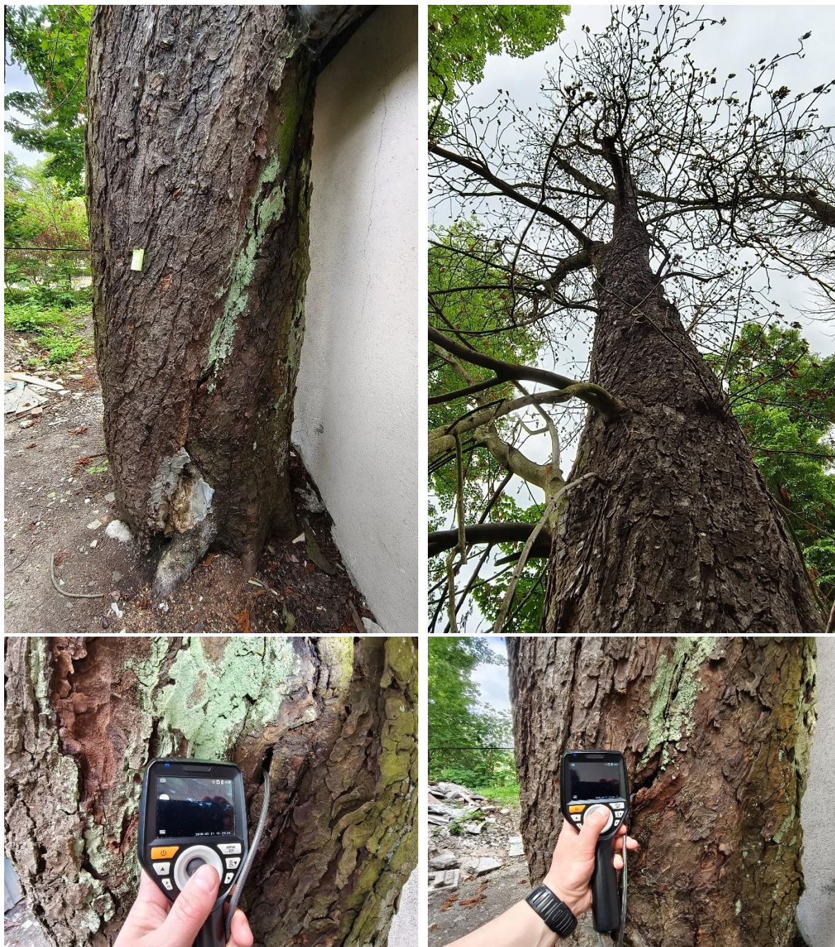
Fot. 5 - 8. Kontrola wnętrza ubytku okołordzeniowego (kominowego), sięgającego od podstawy pnia wysoko w górę pnia. Kontrolę wykonano przez dwie nieduże szczeliny w odziomku pnia. Fot. M. Mydlowski, 31.05.2026 r.
