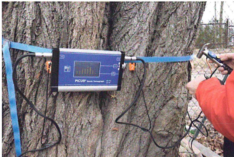
Ryc. 3. Tomograf dźwiękowy Picus 3 do bezinwazyjnego badania stanu zdrowotnego drzew [fot. W. Durlak]
