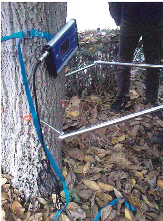
Ryc. 4. Suwmiarka elektroniczna Picus Calliper do pomiaru odległości pomiędzy sensorami [fot. M. Dudkiewicz]
