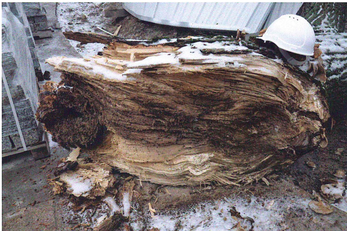
Fot. 2. Fragment odłamanego konaru z widoczną zaawansowaną destrukcją wnętrza (fot. M. Dąbski)
