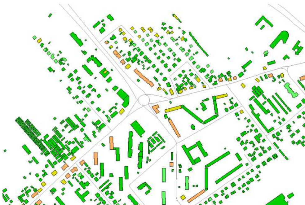
Rysunek 1.10-1 Baza danych Mapy Akustycznej miasta Szczecin zawiera informacje na temat wartości wskaźnika M dla każdego budynku mieszkalnego.
