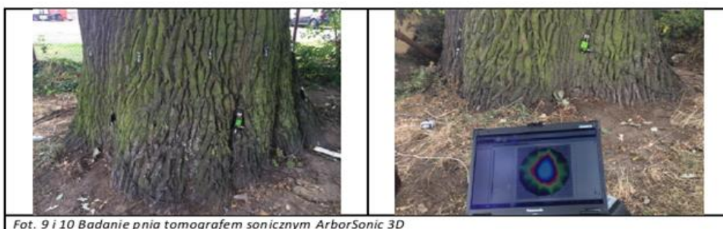
Fot. 9 i 10 Badanie pnia tomografem sonicznym ArborSonic 3D
