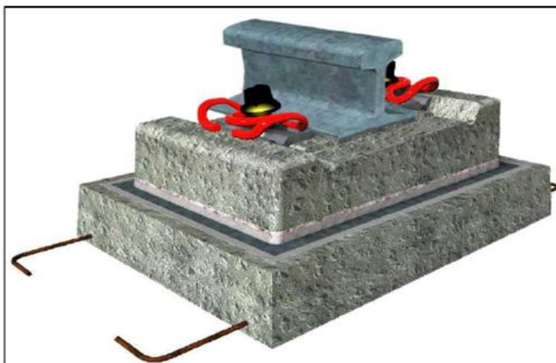
Rysunek nr 13. Przykładowy system podpór blokowych w otulinie
