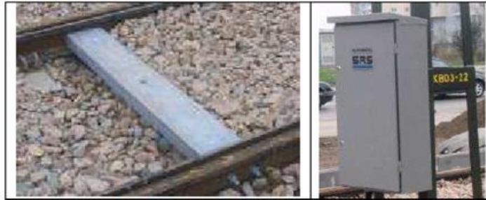
Rysunek nr 17. Przykład smarownicy torowej SRS oraz szafy z aparaturą sterowniczą smarownicy ( http://www.transportszynowy.pl )
