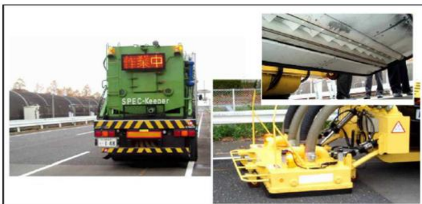
Rysunek nr 9. Sprzęt wykorzystywany przy oczyszczaniu nawierzchni z asfaltu porowatego (Źródło: Zastosowanie nowoczesnych technologii w konstrukcjach drogowych, Zakopane 15-17.09.2010 r.)
