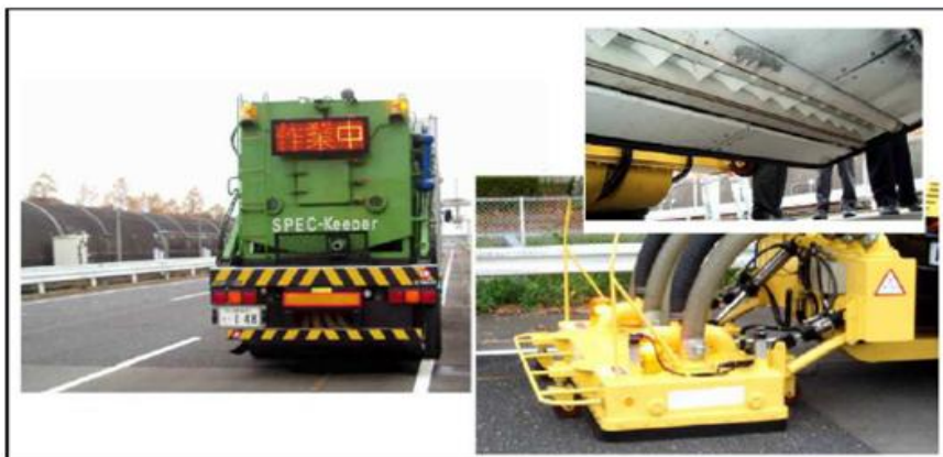
Rysunek nr 12. Sprzęt wykorzystywany przy oczyszczaniu nawierzchni z asfaltu porowatego (Źródło: Zastosowanie nowoczesnych technologii w konstrukcjach drogowych, Zakopane 15-17.09.2010 r.)
