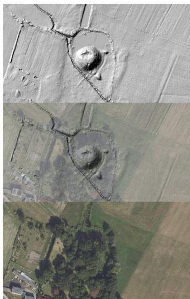
Rysunek 60 Porównanie widoku grodziska w Potarzycy w zobrazowaniu NMT oraz ortofotomapy (źródło: https://geoportal.gov.pl/ ).
