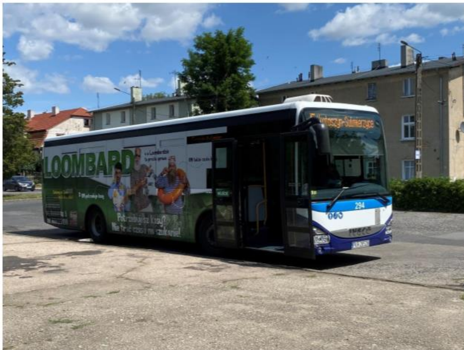
Rys. 4.3 Częściowo niskopodłogowy autobus typu MAXI.
