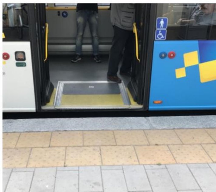
Rys. 9.3 Zminimalizowana przerwa między peronem przystankowym a autobusem
