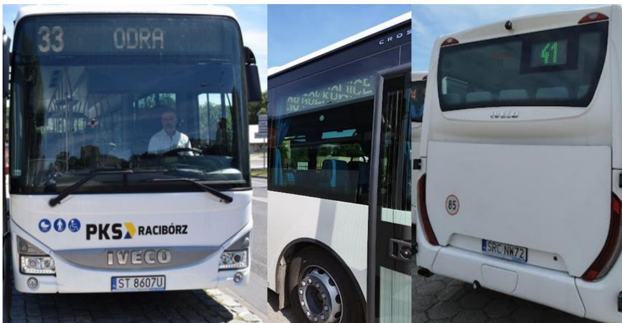
Rys. 21 Elektroniczne wyświetlacze kierunku jazdy i nr linii w autobusach wodzisławskiej komunikacji powiatowej
